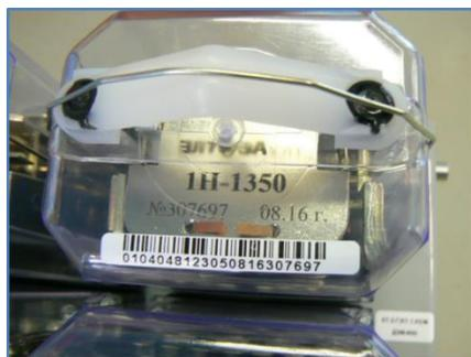
**Рис. 3. Нанесение штрихового кода Code-128 на готовую продукцию**
