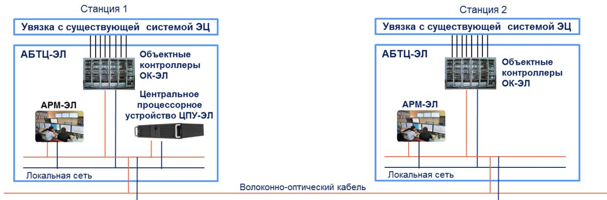
Рис. 8. Микропроцессорная автоблокировка с рельсовыми цепями тональной частоты АБТЦ-ЭЛ
