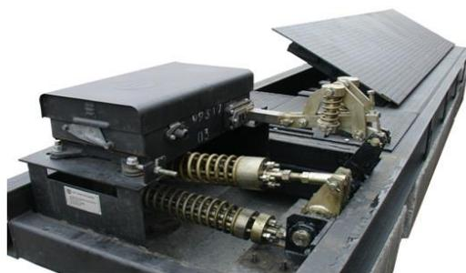
**Рис. 3. Модернизированное устройство заграждения типа УЗм**
