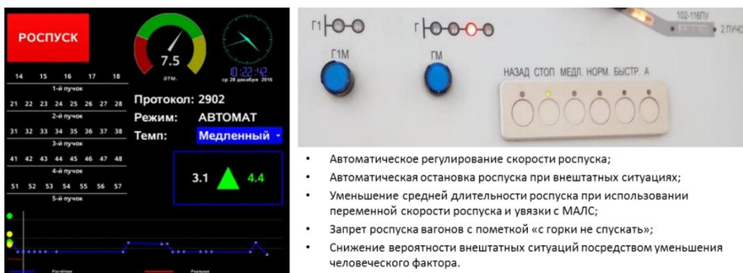
**Рис. 9. Модуль автоматического управления горочным светофором и переменной скорости роспуска**
