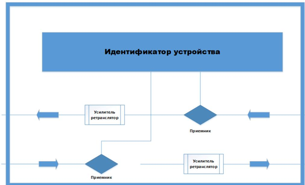
Рис. 2. Концепция модуля приема-передачи данных в локальном контроллере
