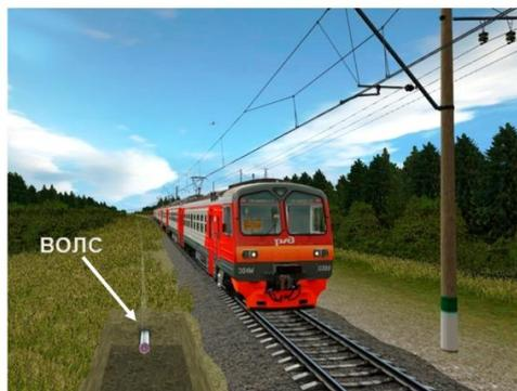
**Рис. 5. Система интервального регулирования движения поездов на основе дистанционного виброакустического зондирования железнодорожного полотна**
