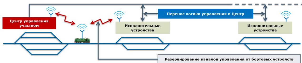
2. Переход к распределенной системе управления объектами на станции с сокращением кабельных сетей и технических зданий
