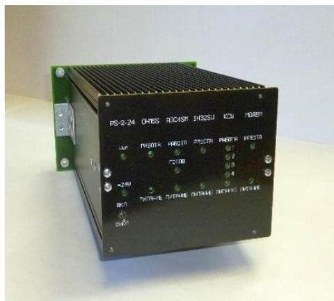
Техническое задание на КДК-СУ согласовано Управлением автоматики и телемеханики ЦДИ, изготовлены опытные образцы КДК-СУ, проведены предварительные испытания и испытания на электромагнитную совместимость комплекса для критерия качества функционирования В, идет подготовка к проведению их эксплуатационных испытаний установленным порядком на головном полигоне.
