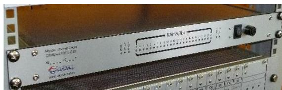
Показатели комплекса выбраны с учетом требований к СТДМ СТО РЖД 11.011-2017, относящимся к аппаратуре сбора данных с перегонов/переездов, положений инструкции по техническому обслуживанию устройств ЖАТ и характеристик кабельных линий связи и линии ДСН на перегонах, комплекс не требует периодического технического обслуживания в период эксплуатации.
