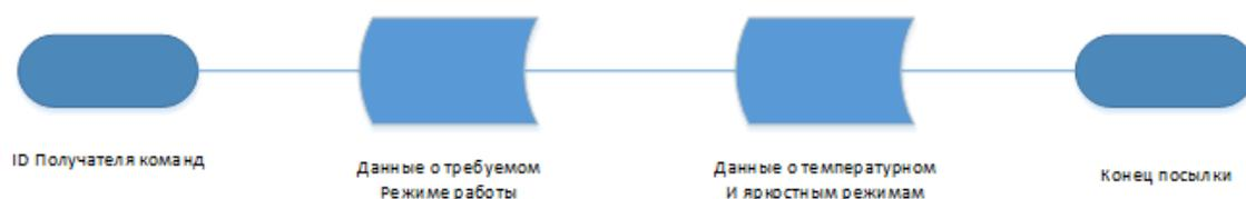
**Рис. 4. общая структура посылки сообщения МПЦ напольному устройству**
