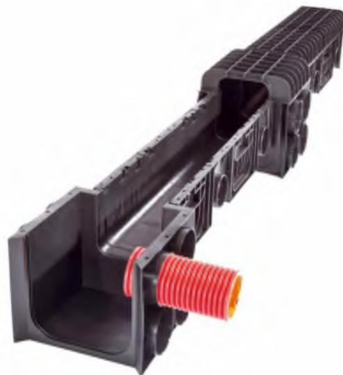
Кабельная канализация производства ЗАО «Легпромразвитие» предназначена для прокладки кабелей сигнализации и блокировки, а также кабелей контрольных и силовых напряжением от 1 - 10 кВ на общей сети железных дорог. Корпуса деталей, входящих в состав кабельной канализации, изготовлены из прочного полипропилена, соединяются между собой специальными клипсами.
