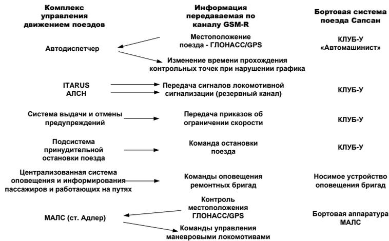
Рис. 3. Применение GSM-R для передачи данных в системах управления
