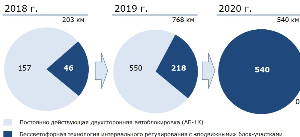
**Рис. 6. Техническое перевооружение устройств автоблокировки по снятию инфраструктурных ограничений в программах модернизации железнодорожного пути**
