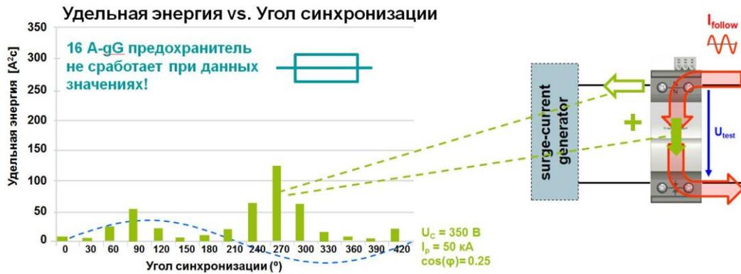
**Рис. 2. Зависимость выделяемой энергии от угла фазового сдвига напряжения питающей сети**
