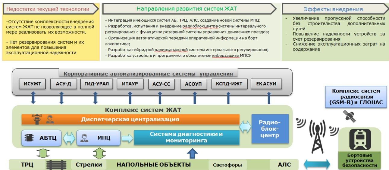
**Рис. 5. Недостатки текущей технологии, направления развития систем ЖАТ и эффекты внедрения цифровой железной дороги**
